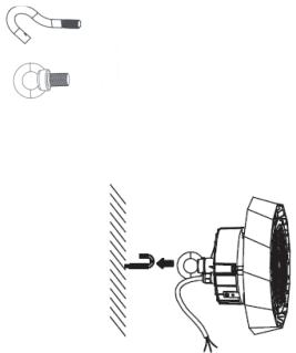
Wywierć otwór w suficie i zainstaluj hak.
